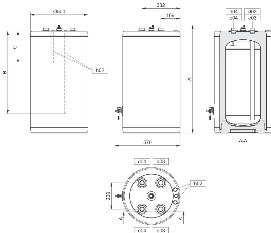
Priključne i montažne mjere podne izvedbe spremnika
