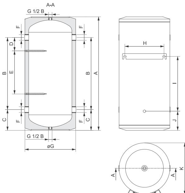
Aansluiting- en installatiematen van de buffertank die aan de wand wordt gemonteerd
