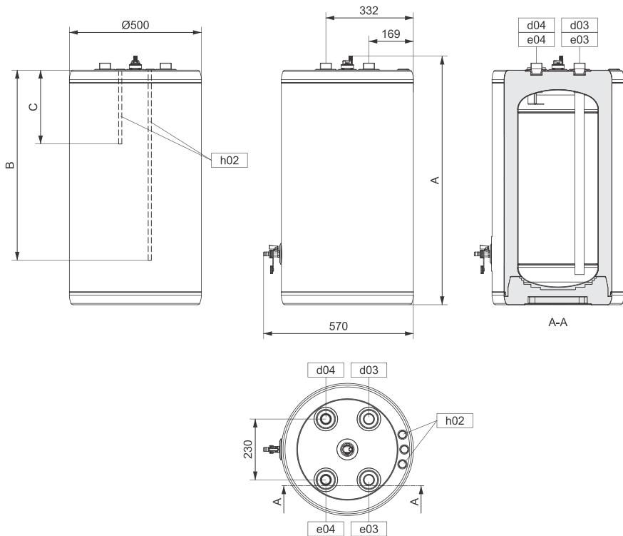
Aansluiting- en installatiematen van de staande uitvoering van de buffertank
