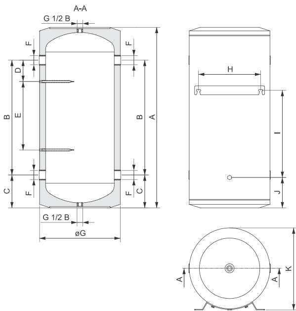
Priklučne i montažne mjere zidne izvedbe spremnika
