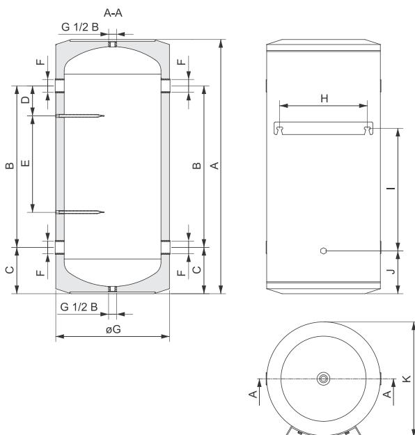
Dimensiunile conexiunii și instalării a versiuni montată pe perete rezervorului tampon
