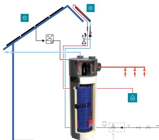
4 DHW CLT + PV system + Solar panel
